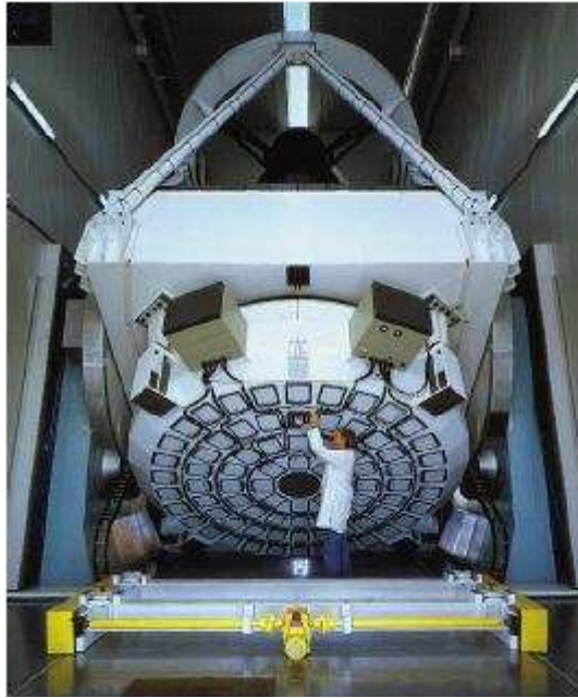
Figura 4 Telescopio NTT di La Silla. Nella foto sono visibili gli attuatori per l'ottica adattiva.
